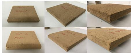
Abbildung: Typhaschaum aus *Typha angustifolia* (oben) mit einer Dichte von  $65 \text{ kg/m}^3$  und *Typha latifolia* (unten) mit einer Zieldichte von  $74 \text{ kg/m}^3$ .
