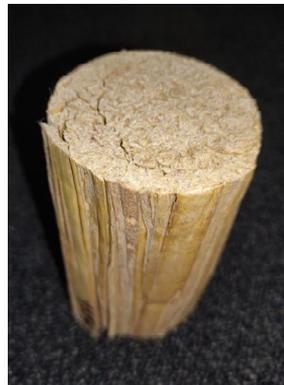
Probekörper nach Druckfestigkeitstest
